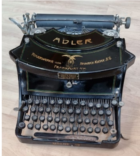
Ђириличка писаћа машина Adler Mod 15 из 1918. године, са три реда слова, коју је Адвокатска комора Србије користила до почетка употребе компјутера, са штампачем. Машину је одржавао овлашћени сервисер Иван Шварц. (Из „фондуса” адвоката Миленка П. Радића).
